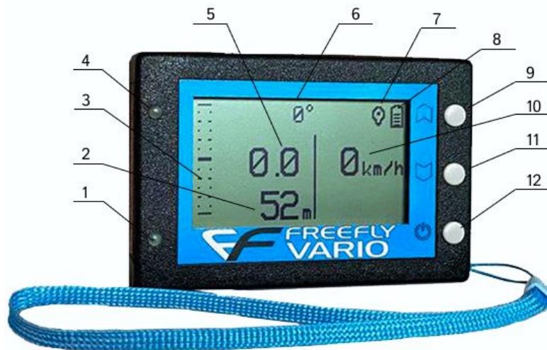
Рис.1 общий вид вариометра и элементов управления: 1 – индикатор заряда, 2 – высота над уровнем моря в метрах, 3 – шкала линейного вариометра, 4 – синий индикатор, 5 – цифровой вариометр, 6 – указатель курса в градусах, 7 – статус индикатор GPS приёмника, 8 – индикатор уровня заряда, 9 – кнопка «вверх», 10 – скорость относительно земли, 11 – кнопка «вниз», 12 – кнопка подтверждения/выключения/смены громкости.
